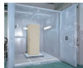
防尘试验例(IP5X)
