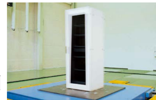
注意 抗震性能实验示例 抗震性能以我公司的装置搭载条件为准。可搭载重量因产品种类、规格、搭载条件(重心位置)、安装环境等而异。NEBS的抗震性能实验仅在水平方向进行。
